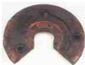
Повреждение установочного корпуса подшипника
