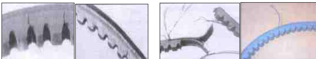
Повреждения при проскальзывании ремня
