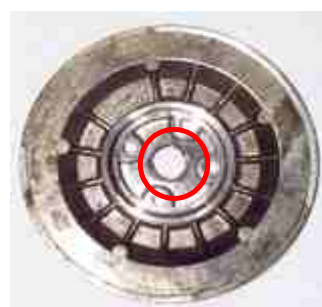
Повреждения задней части тарелки
