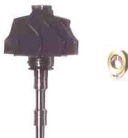
Повреждение вала в результате схватывания с подшипником
