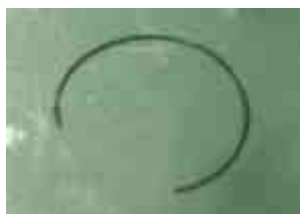
Повреждение масляного уплотнения
