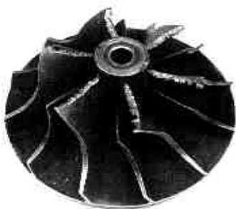
Повреждение лопаток турбины
